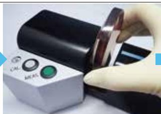
基板を受光窓(青丸)へ接するようにセットします。
